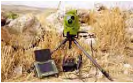
מכלול GTADS - מערכת אלקטרו אופטית עם ציין לייזר
