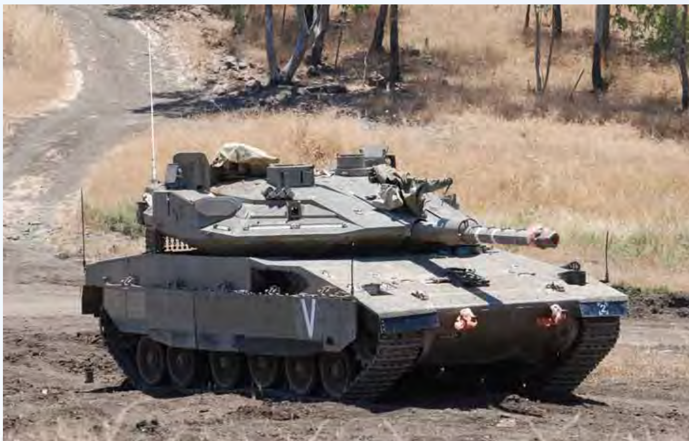
מערכת ההגנה אקטיבית "מעיל רוח" שהורכבה על טנק המרכבה סימן 4
