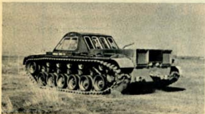
ציוור מס' 4: מרכב שכ טנק פטון אמריקאי הנושא מנוע טורבינה בעת נטוי.
