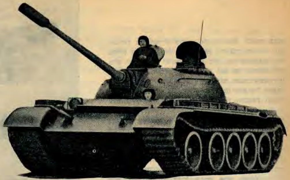
תמונה 1: טנק T-54. שים לב למבנה השטוח של התובה והצריח וכן למרוח האופייני בין גלגל המרכוב הראשון והשני.
