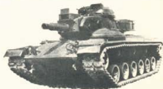
הטנק M-60-A1E1, צריח חדש על תובה ומזקי"ם של M-60. הטנק M-60-A1E2 מורכב מאותו צריח ומתובה ומזקי"ם של M-60-A1.
