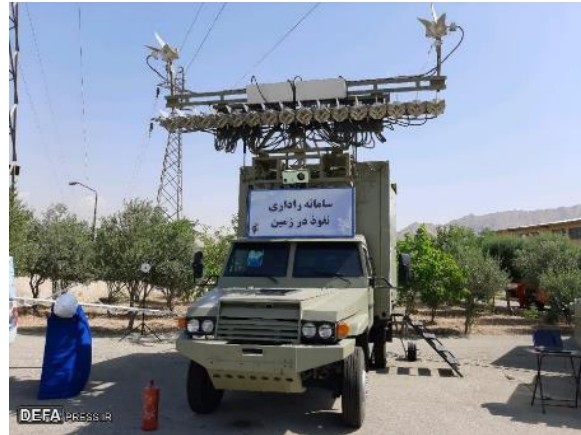
מכ"ם חודר קרקע לגילוי מוקשים ומטעני צד. מקור: DEFA
