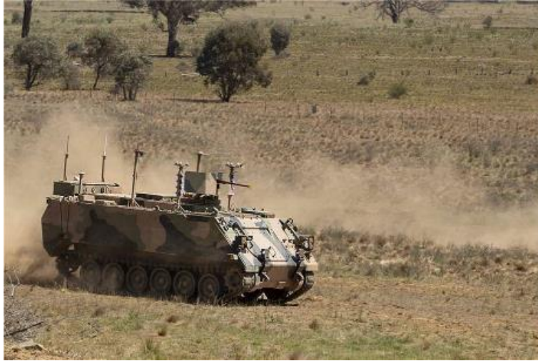
הנגמ"ש האוסטרלי M113AS4 בגרסה האוטונומית. (מקור: משרד הביטחון האוסטרלי)
