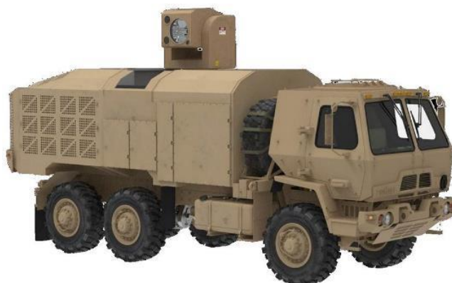
איור של אב טיפוס מערכת נשק לייזר בעוצמה 300 קילואט ע"ג משאית FMTV. מקור: U.S. Army
