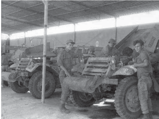
החלפת מצמד ותיבת הילוכים בזחל"מים בסדנת בלוזה
